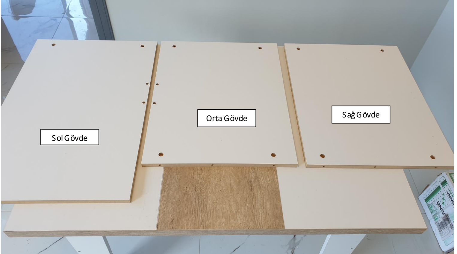
Masamızın gövdeleri resimdeki gibi 3 adettir. En büyük olan parça masamıza karşıdan bakınca sol gövdedir. diğer 2 tane eşit ölçüde olan parçalardan 6 delikli olan parçamız orta gövde ve 4 delikli olan parça sağ gövdedir.
